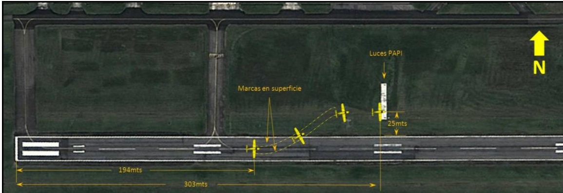
Diagrama de la Excursión de Pista y posición final de la aeronave HK1577G
