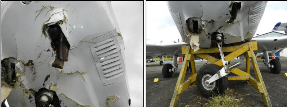
Fractura del tren de aterrizaje delantero y abolladuras en la cubierta inferior del motor
